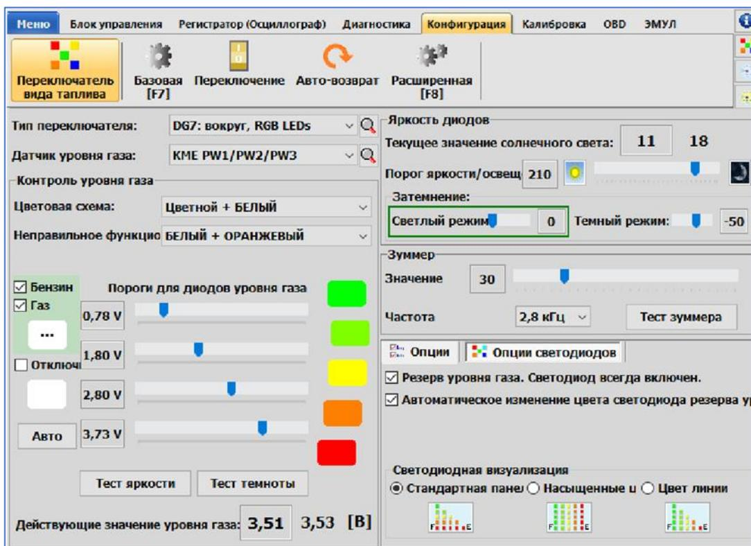
Рис. 2.49 Окна конфигурации для различных переключателей видов топлива
