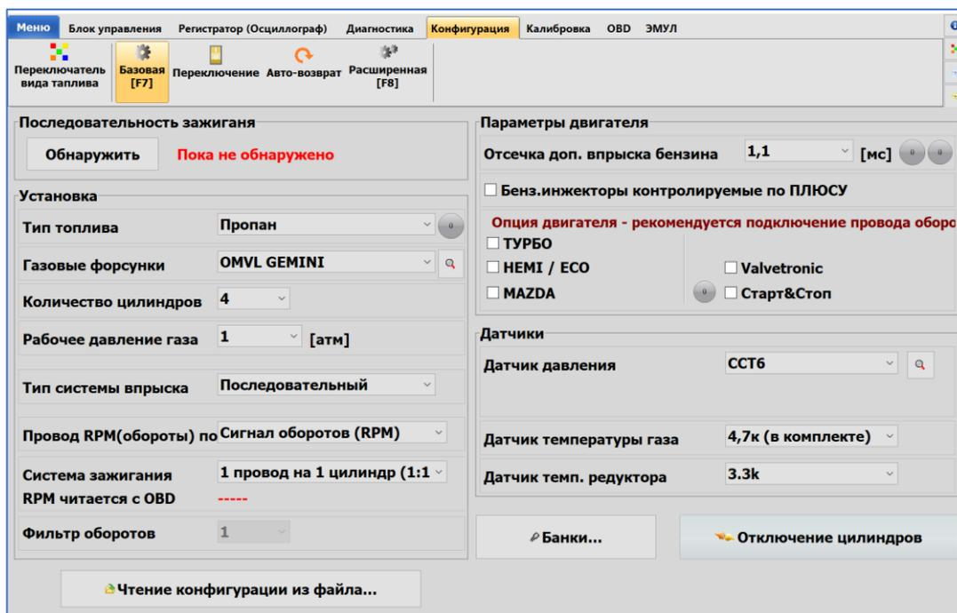
Рис.2.52 Окно базовой конфигурации (вид для контроллера MAX)
