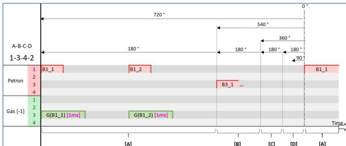
Рис. 2.114 Визуализация углового сдвига (короткое время подачи газа)
