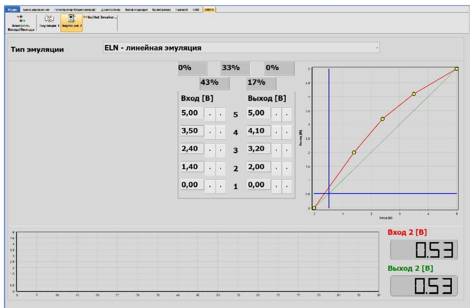
Рис. 2.136 Окно настроек линейной эмуляции в контроллере DIRECT
