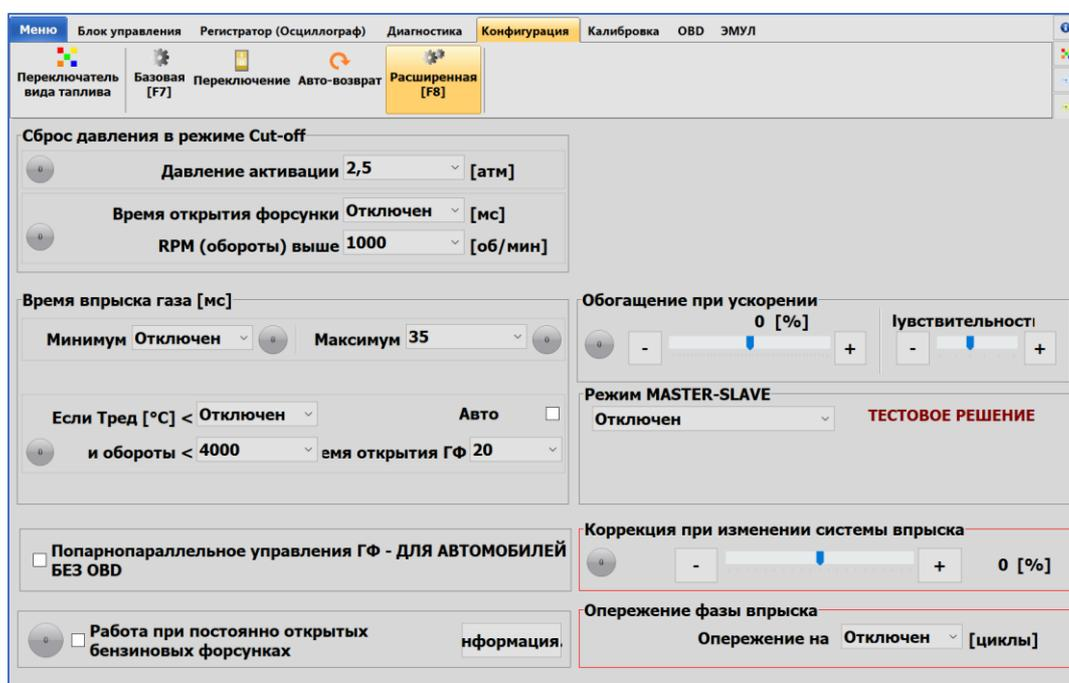
Рис. 2.58 Вкладка «Расширенная» (вид для контроллера MAX)
