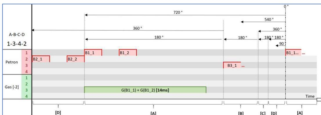
Рис. 2.119 Визуализация стратегии [-2] и углового газового сдвига
