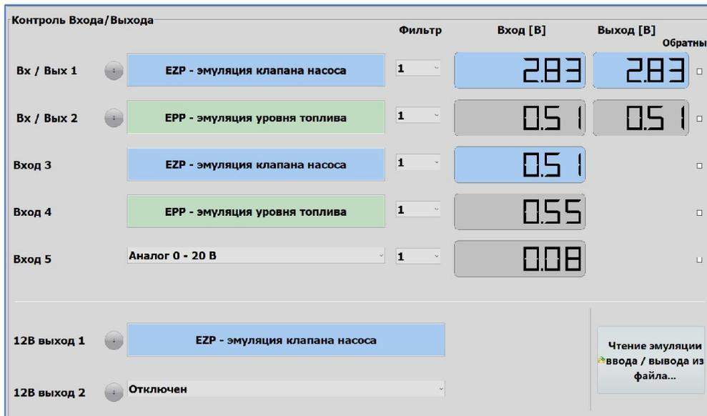
Рис. 2.139 Вкладка «Контроль Входа / Выхода» после включения эмуляции EZP
