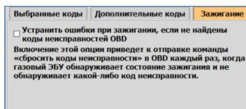
Рис. 2.130 Дополнительный механизм автоматической очистки при включении зажигания
